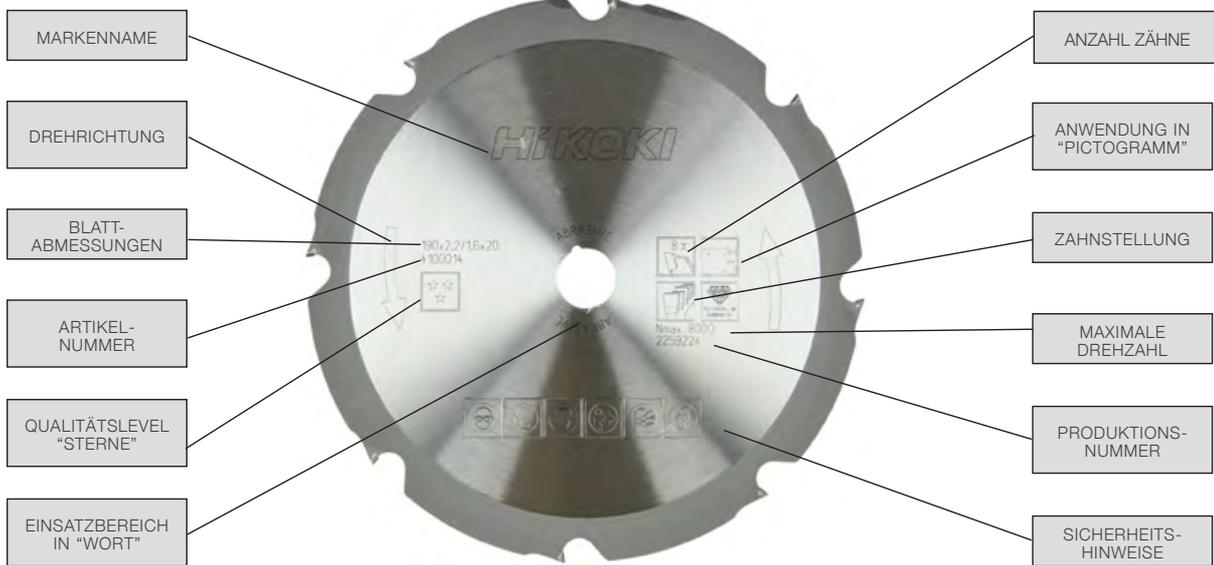
Die HiKOKI Polykristalline Diamant (PCD) Sägeblätter bestehen aus einem Stahlkörper auf dem Hartmetallelemente aufgelötet werden, die mit einer Diamantschicht gesintert ist. Das Ergebnis ist ein dreimal härterer Zahn als Wolframkarbid und erreicht ein Vielfaches an Schnitten in geeigneten Materialien. Die PCD Sägeblätter haben über viele Jahre hinweg diese Eigenschaften und haben sich bei Spanplatten, Faserplatten, Holzwerkstoffen
